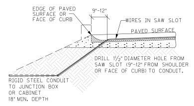
SAW SLOT EDGE OF PAVEMENT TRANSITION
